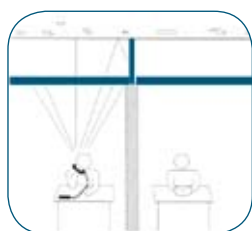
Figur 2: Skillevegg montert med Rockfon Soundstop
